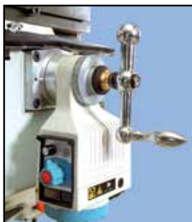
Strojní posuv s plynulou regulací a rychloposuvem
