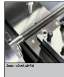
Všechny pohybující se součásti vřeteničky SPA-500P jsou mazány olejovou lázní
