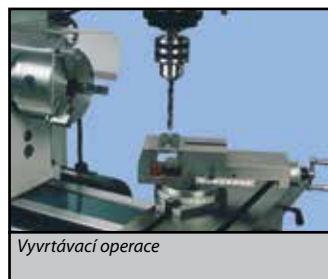
Odmontováním nožové hlavy máme k dispozici svěrák
