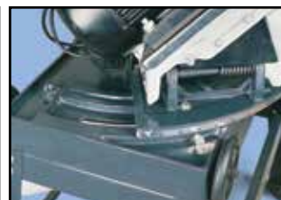
Natáčení ramene při řezání pod úhlem (PPK-115U)
