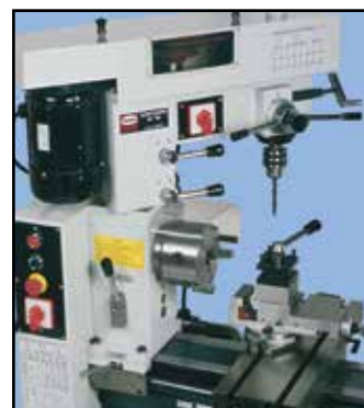
Frézovacím zařízením je možné otáčet
