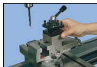
Odmontováním nožové hlavy máme k dispozici svěrák
