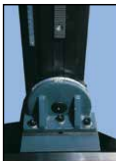
Frézku lze v podélné rovině stolu nastavit pod úhlem \pm 45^\circ
